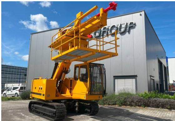
UNIDACHS 423 - Konverter Abstichlochbohrmaschine
